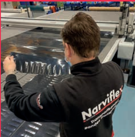
Rubber stroken op rol, met gaten en sleufgaten / Bandes de caoutchouc en rouleaux, avec trous et trous oblongs
