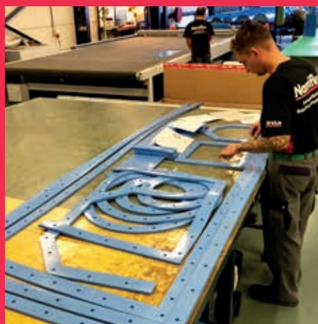
Rubber stroken op rol, met gaten en sleufgaten / Bandes de caoutchouc en rouleaux, avec trous et trous oblongs
